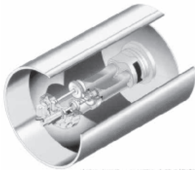
バリオマチックドラム内部の構造
