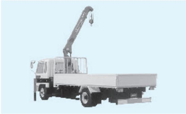
任意の停止位置を設定できるので、ブームの高さに注意を要する屋内や鉄道架線下・電線下などの作業現場で威力を發揮!
