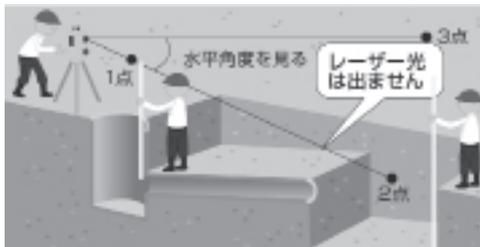
直線を出したいときに、その線上で2点を計測します。よくパイプレーザー使用時に直線を出す為に併用されます。
