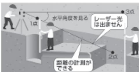
セオドライトの機能にプラスして距離の測定が可能です。付属のプリズムを取り付けた棒を持つ人を別に設けて測定する。
