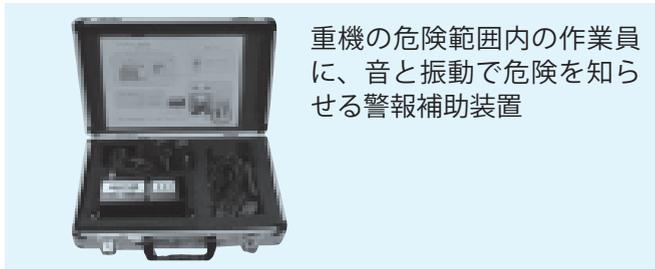
重機の危険範囲内の作業員に、音と振動で危険を知らせる警報補助装置
