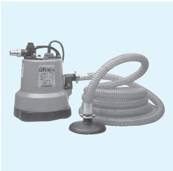
ハイスピン（過流）羽根車の採用で、砂・泥等によるロックや摩擦に強い構造です。サイホンブレーカー機構の逆止弁により、ポンプ停止時の揚水の逆流・封水抜けを防止します。
