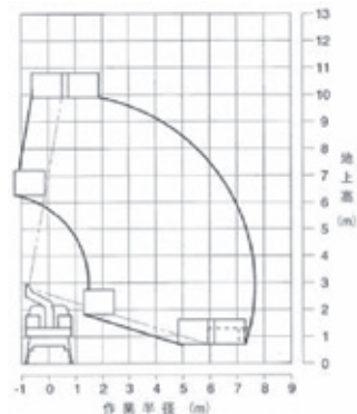
10m電工用スカイマスター
