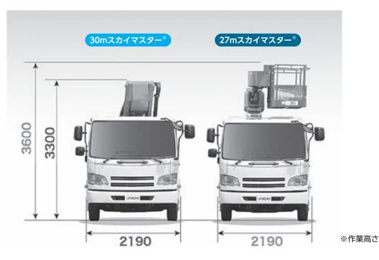
限定中型自動車免許で運転できるように、車両総重量8t未満に抑えたほか、車両全幅やアウトリガ張出し幅を、 1クラス下(作業床最大地上高27m)の高所作業車と同寸法に抑えています。車両全高も3.3m以下に抑えており、 コンパクトな車体で車両運用の容易化、効率化に貢献します。
