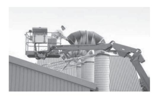
屈折アームの採用により、障害物をかわしやすくなり、作業対象に対するアプローチが容易になりました。ま た、1つのレバー操作で水平面や垂直面に沿って移動する「垂直・水平移動制御モード」や、起伏下げ操作時に 作業範囲の規制で停止せず、作業範囲の内側に沿って移動する「ノンストップ規制モード」を装備しており、様々 な作業で扱い易く、効率的な作業に貢献します。
