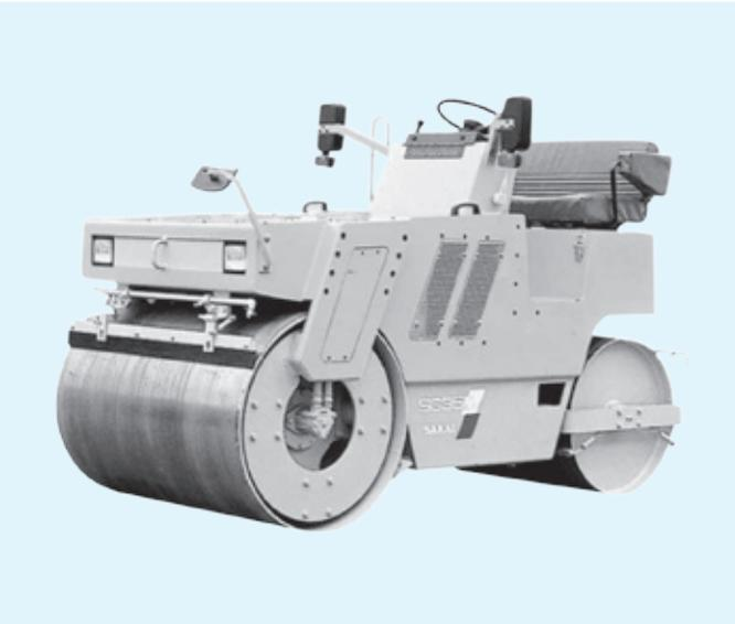
全油圧式のローラーで路床からアスファルト工事まで、その用途も幅広くあらゆる条件下でも十分に満足させ、期待にこたえる高性能振動ローラーです。
