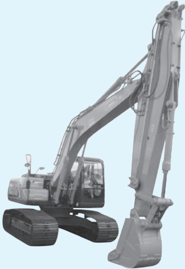
伸縮自在のアームは簡単なペダル式のスライド操作で、しかもローラー装置により伸縮はスピーディーです。
