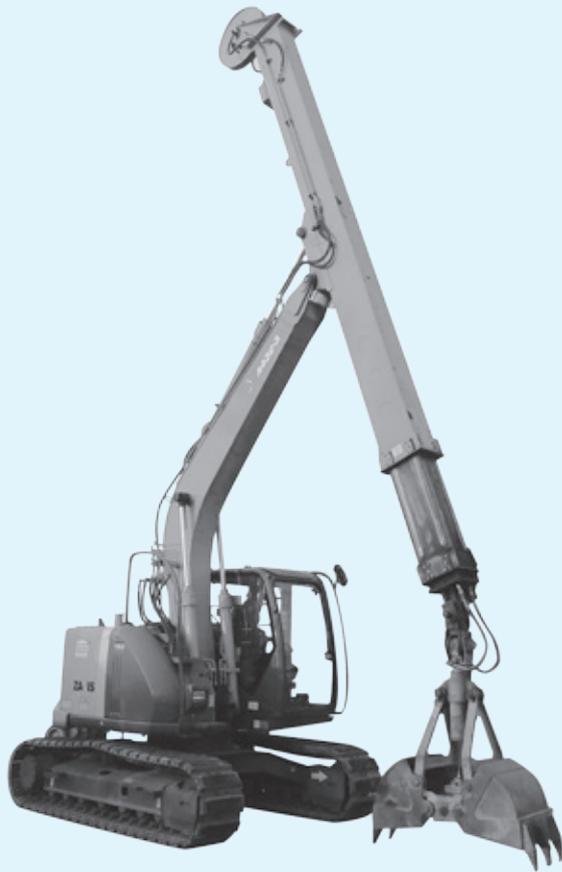
油圧シリンダによる多段伸縮アームとシェルプッシュ式クラムシェルの組合せでパワフルな掘削を実現。
